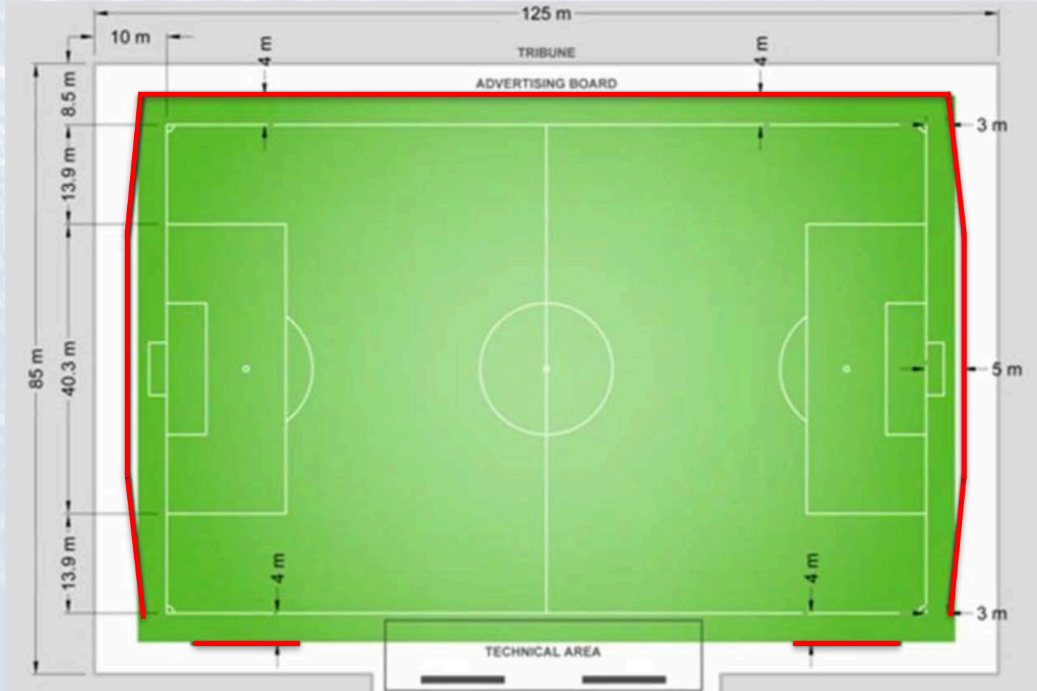
Vereiste locatie en afstanden van de reclameborden tot het veld tijdens EURO 2020 (minimaal 90 cm hoogte)
